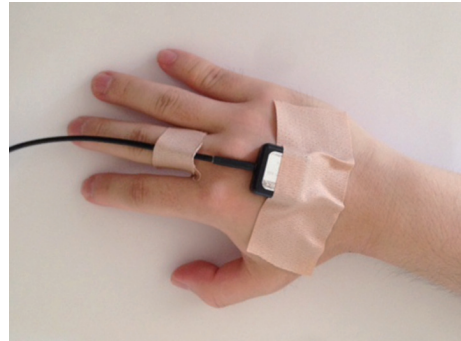
図4 3軸ジャイロセンサ取り付け位置
